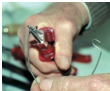
5. Piegare l'estremità con l'anello verso l'interno e assicurarsi che sia ben chiuso.
