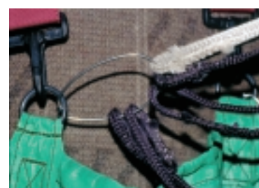
10. Il gancio sostiene la prima delle reti contenute nella sacco.
